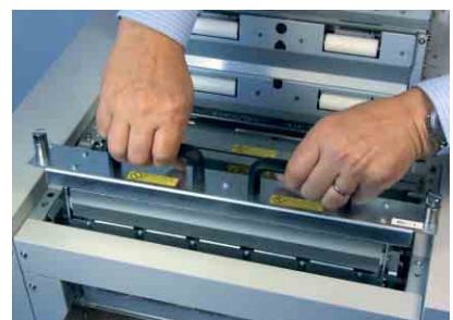
Schneller und einfacher Wechsel der Längsmesser für verschiedene Formate
