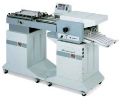
multipli 35/2/PBA 2 Falztaschen, Unterflursauganleger mit integriertem Ausrichttisch
