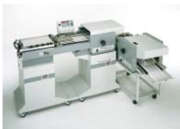
multipli 35/2/4/PBA 2 Falztaschen in 1. Falzwerk, 4 Falztaschen im 2. Falzwerk, Unterflursauganleger mit integriertem Ausrichttisch
