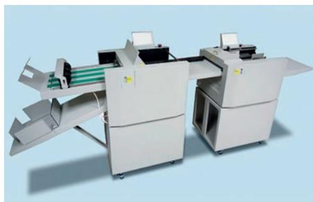
Die **Lightning Fold Pro**, ein Alleskönner. Schneiden, Rillen, Perforieren und Falzen, 7 Falzarten, bis Format 330 x 650 mm. Die dem Falzmodul vorangestellte Rill- und Perforiermaschine kann auch als Solomaschine betrieben werden. Partiiell abgesetzte Längs-Perforationen, verschieden breite Rillungen oder Kiss-Cuts sind problemlos herzustellen.
