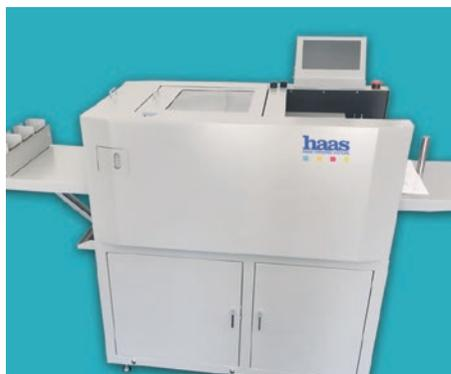
**Muti-Finisher Cut Pro**, die neue **Serie 6** das Multifunktions-Topmodell, perfekt zum schnellen Längs- und Querschneiden verschiedenster Bogenformate und Materialien. Mit 6 unabhängig positionierbaren Längsschnittwerkzeugen lassen sich alle Schnittmuster realisieren. Im selben Arbeitsgang kann gerillt und/oder perforiert werden (längs, quer, abgesetzt) bis Format 330 x 900/1200 mm. Papierstärken 01.mm-0.4mm, bis 8'000 Bg/h.
